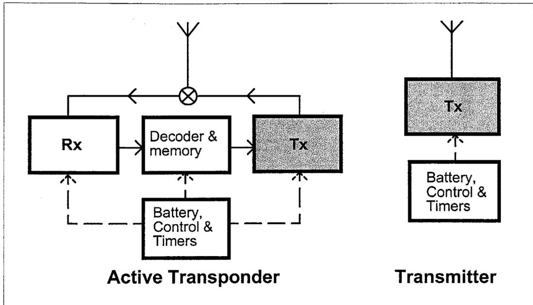
FIGURE 1. COMPONENTS OF A SIMPLE RADIO ACTIVE TRANSPONDER SHOWING TRANSMITTER (Tx), ADDITIONAL RECEIVER (Rx), DECODER AND A WILDLIFE TRANSMITTER.
